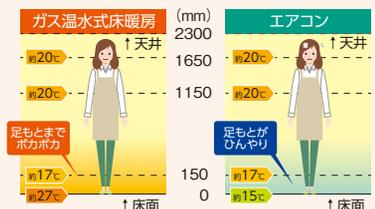
【出典】東邦ガス実測値<試験条件>床暖房:敷設率68%、20℃設定
