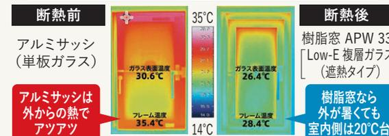
[サーモグラフィ撮影条件] 室外温度32.6°C/室内温度25.3°C [出典] YKK AP株 ※写真はイメージです。※断熱後の温度改善は設置条件・時期・時間等により異なります。
