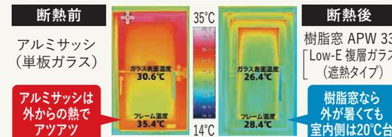
[サーモグラフィ撮影条件] 室外温度32.6°C/室内温度25.3°C [出典] YKK AP 樹脂窓 ※写真はイメージです。 ※断熱後の温度改善は設置条件・時期・時間帯により異なります。
