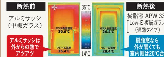
[サーモグラフィ撮影条件] 室外温度32.6℃/室内温度25.3℃ 【出典】YKK AP株 ※写真はイメージです。 ※断熱後の温度改善は設置条件・時期・時間等により異なります。
