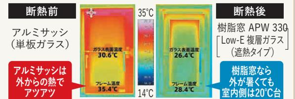
[サーモグラフィ撮影条件] 室外温度32.6°C / 室内温度25.3°C 【出典】YKK AP株 ※写真はイメージです。※断熱後の温度改善は設置条件・時期・時間等により異なります。
