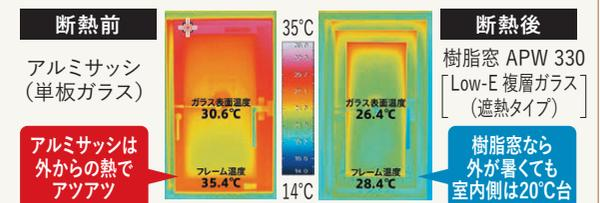
[サーモグラフィ撮影条件] 室外温度32.6℃ / 室内温度25.3℃ 【出典】YKK AP株 ※写真はイメージです。※断熱後の温度改善は設置条件・時期・時間等により異なります。
